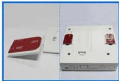
1. 将壁挂扣安置在壁挂孔上
