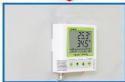
3. 揭下胶皮，将设备扣置在墙面（水平安装，请勿倾斜）
