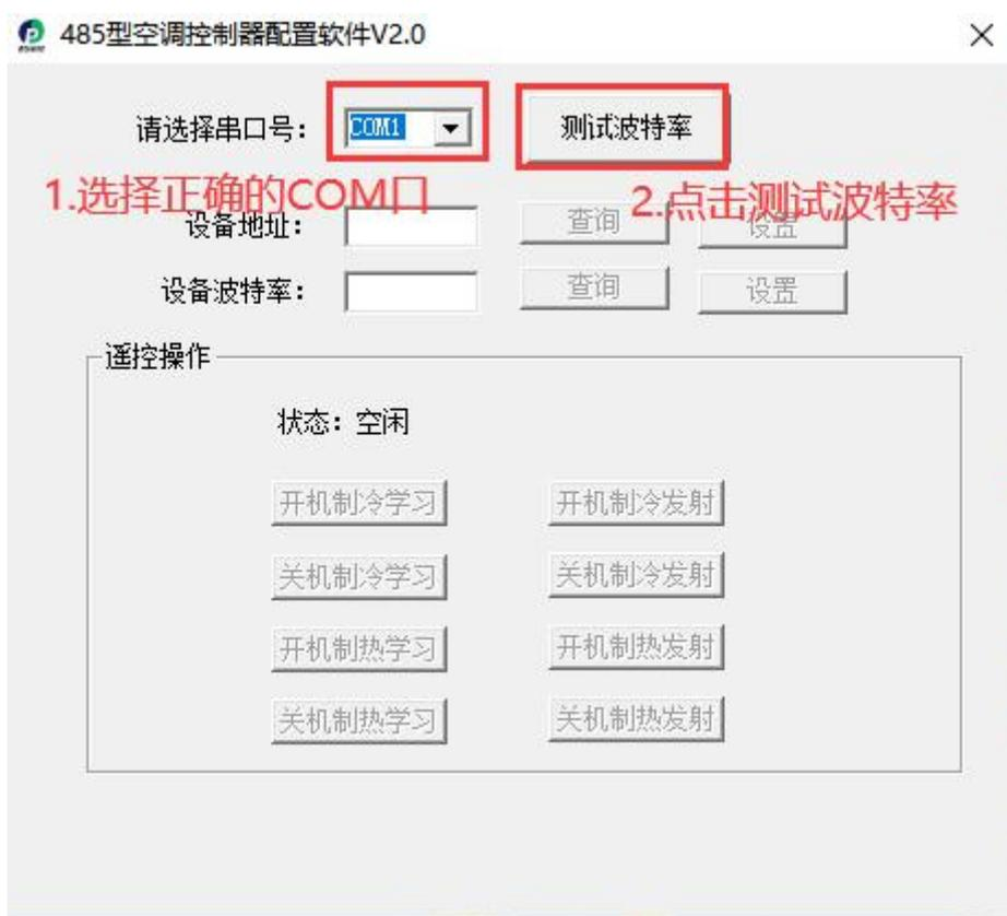
6) 将空调遥控器设置为制冷模式，关机，然后点击“开机制冷学习”按键，COMM 灯会 1s 闪一次，持续闪 12s，用户必须在 12s 之内进行学习，软件上会显示倒计时。在 12s 以内将空调遥控器的发射灯对准 RS-KT-N01 的发射灯，间距 5cm 以内。然后按空调遥控器的“开机/关机”按键。若学习成功则 COMM 灯会快闪 3 下，软件会提示学习成功，否则提示学习失败。若学习失败，请再次点击“开机制冷学习”按键重复上面操作。若学习成功，将 RS-KT-N01 设备的红外发射头对准空调，然后点击“开机制冷发射”按钮，点击“开机制冷发射”按钮时 COMM 灯会闪一下，若空调能够正常开机并自动处于制冷模式则说明“开机制冷”学习
