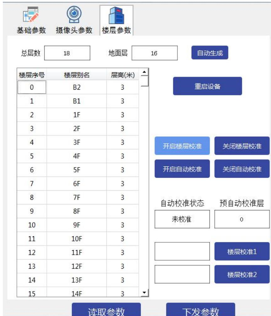
设备在设置完楼层参数后需要对设备进行校准，校准的方式分为逐层校准和极限校准。
