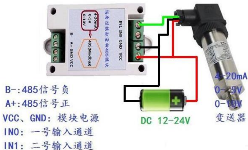
三线制设备接线图
