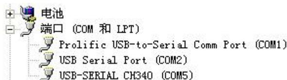
②将控制器的从站 485 端口通过 USB 转 485 模块接入到电脑，控制器供电后，长按设置按键 3 秒或以上，运行指示灯长亮后进入参数配置模式，这时点击配置软件的刷新按钮，刷新串口列表，选择对应的串口号后，点击软件的“参数读取”按钮，软件会识别出当前控制器的波特率、数据位、停止位、校验位、以及超时时间，默认波特率为 9600bit/s、无校验位、超时时间为 1000ms。
