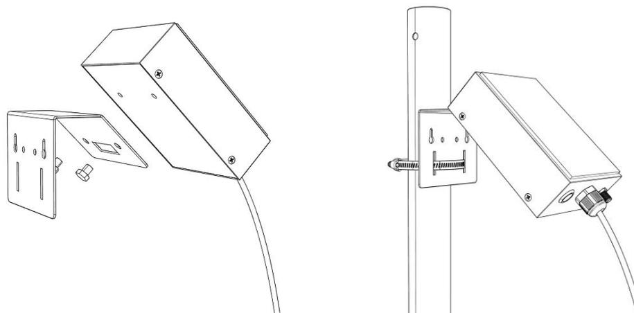
取无线 485 数据采集器壁挂抱杆配件，从螺丝包取出两枚 M5 螺丝将配件安装到无线 485 数据采集器背面两个安装孔，后续将组转完成的设备使用喉箍安装到立杆上即可。
