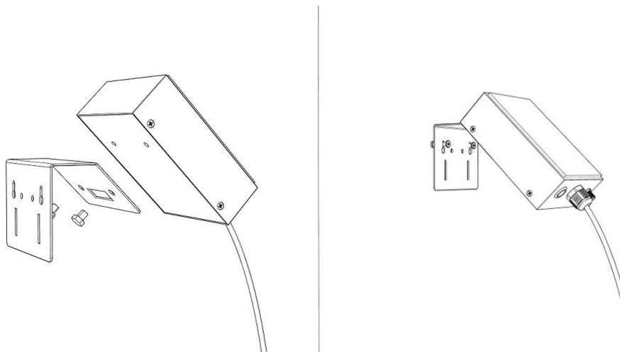
取无线 485 数据采集器壁挂抱杆配件，从螺丝包取出两枚 M5 螺丝将配件安装到无线 485 数据采集器背面两个安装孔
