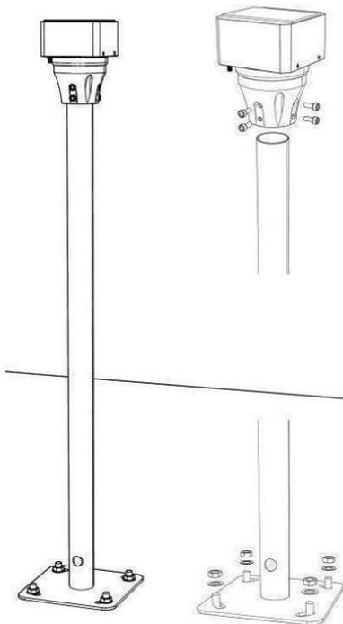
1、取无线 485 数据采集器立杆，敲击靠近底座处的微联孔，将圆孔处铁片敲掉。
