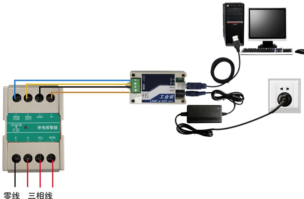
我司提供配套的“485 参数配置软件”，可以方便的使用电脑读取传感器的参数，同时灵活的修改传感器的设备 ID 和地址。
