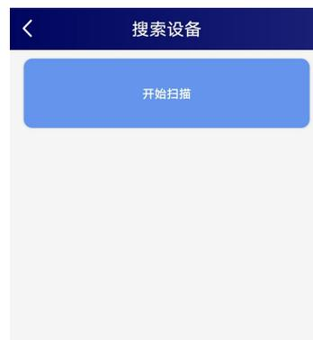
(2) 设备长按 **ENTER** 键，左下角显示“DISC”，表示进入蓝牙配置模式。点击“开始扫描”搜索需要配置的设备，设备名称为 WIFIC3 加设备地址，例设备地址为 12345678，选择 WS12345678 即可。
