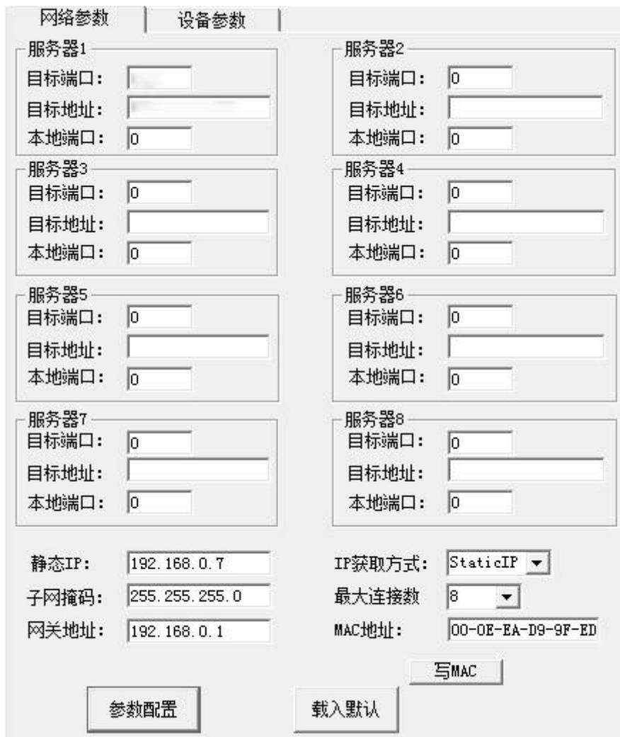
当设备通过网口将数据上传至监控平台时，建议客户只设置服务器 1 的目标地址和目标端口，同时上传多个服务器不稳定，服务器 2-8 如上图一样清空即可，设备 IP 可设置为静态 IP 或动态获取 IP。
