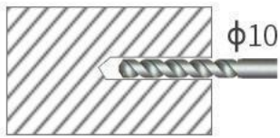
▲ 钻孔 (孔径10mm)
