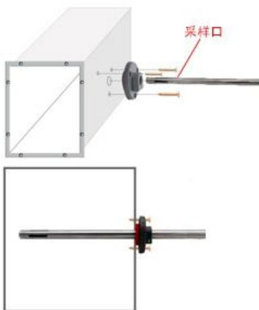
油烟传感器上的法兰盘的位置可调，用户可以根据自己的需求调节法兰盘控制油烟采样头进出长短。
