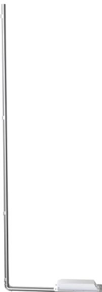
将 L 型支架贴在墙壁上，多普勒流速仪正对下水道水流的方向，选择适当的位置高度水平放置，预先在下水道墙壁上距 L 型支架顶端 10cm 处用电钻打两个直径 10mm 的孔，水平孔距 50mm，然后垂直向下每隔 50cm 打一对孔，放入膨胀塞，使用扳手拧紧膨胀螺丝将 L 型支架通过 M22 管卡固定到下水道墙壁上，安装效果如下。
