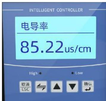
电导率测量模式界面
