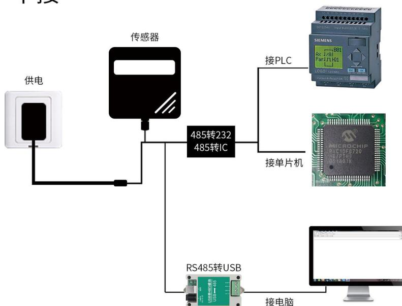
本产品也可以多个传感器组合在一条 485 总线使用，理论上一条总线可以接 254 个 485 传感器，另一端接入带有 485 接口的 PLC、通过 485 接口芯片连接单片机，或者使用 USB 转 485 即可与电脑连接，使用我公司提供的传感器配置工具进行配置和测试（在使用该配置软件时只能接一台设备）。
