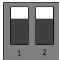
图 4 所示：拨码开关对应量程 0~10m/s
