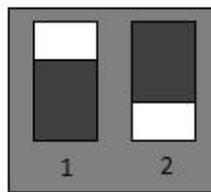
图 3 所示：拨码开关对应量程 0~15m/s
