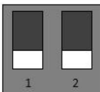
图 1 所示：拨码开关对应量程 0~20m/s
