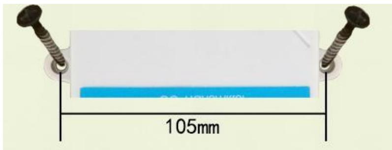
壁挂王字壳为壁挂式安装，安装孔位于设备两侧中部位位置，安装孔径小于 4mm，孔距 105mm，可使用 3mm 的自攻螺丝安装。
