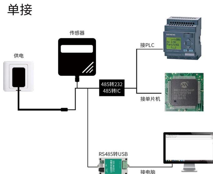
本产品也可以多个传感器组合在一条 485 总线使用，理论上一条总线可以 254 个 485 传感器，另一端接入带有 485 接口的 PLC、通过 485 接口芯片连接单片机，或者使用 USB 转 485 即可与电脑连接，使用我公司提供的传感器配置工具进行配置和测试（在使用该配置软件时只能接一台设备）。
