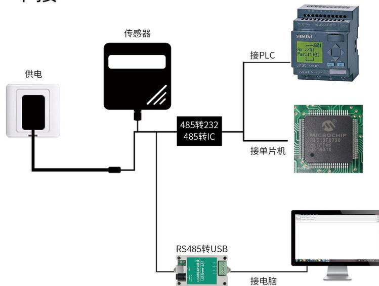
本产品也可以多个传感器组合在一条 485 总线使用，理论上一条总线可以 254 个 485 传感器，另一端接入带有 485 接口的 PLC、通过 485 接口芯片连接单片机，或者使用 USB 转 485 即可与电脑连接，使用我公司提供的传感器配置工具进行配置和测试（在使用该配置软件时只能接一台设备）。
