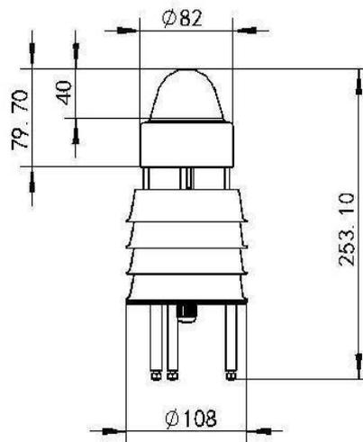
带光学雨量要素尺寸图（单位：mm）
