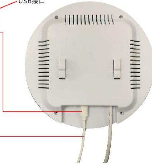
**注意：拔下 USB 线时不要捏住 USB 头部拔下，以免损坏 USB 插口！**
