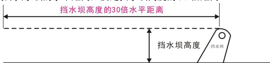
离开挡水坝高度 30 倍水平距离安装
