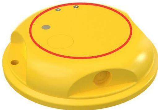
使用唤醒磁铁围绕监测终端设备（红圈处）快速旋绕3圈，听到蜂鸣器“滴~”的响声后打开“蓝牙碰一碰APP”进行校准。
