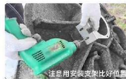
第二步：选择合适安装位置，确定传感器安装位置并使用电钻打孔
