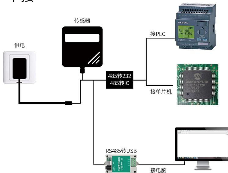
本产品也可以多个传感器组合在一条 485 总线使用，理论上一条总线可以 254 个 485 传感器，另一端接入带有 485 接口的 PLC、通过 485 接口芯片连接单片机，或者使用 USB 转 485 即可与电脑连接，使用我公司提供的传感器配置工具进行配置和测试（在使用该配置软件时只能接一台设备）。
