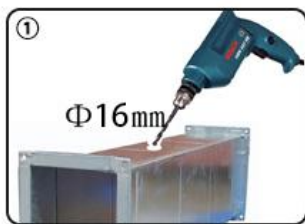
在排风管上打一个直径16mm的孔
