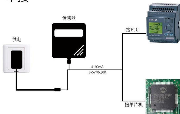
当系统需要接入多个模拟量版本传感器时，需要分别将每一个传感器接入每一个不同的单片机模拟量采集口或者 PLC 的 DI 接口，同时根据后文的换算关系编写相应的采集程序即可。
