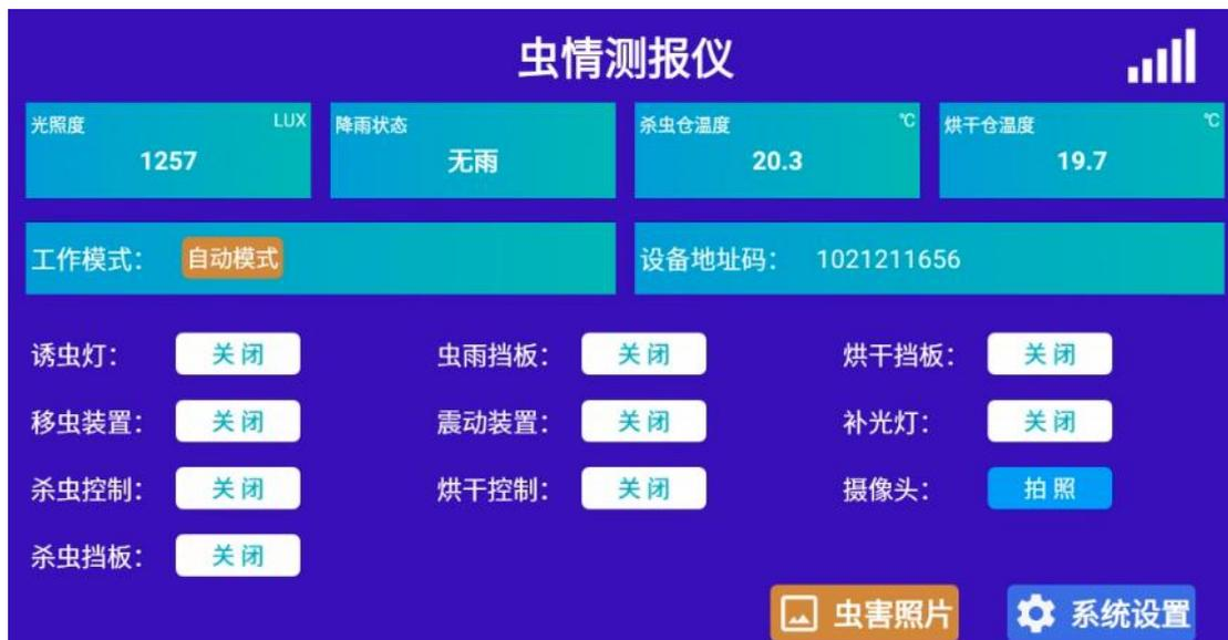
该界面可显示光照度、降雨状态、杀虫仓温度、烘干仓温度、设备工作模式、设备地址码。同时可以显示当设备的运行状态，包含诱虫灯、虫雨挡板、烘干挡板、移虫装置、震动装置、补光灯、杀虫控制、烘干控制、杀虫挡板，也可以将设备调成手动模式，单独控制设备的各个部件。
