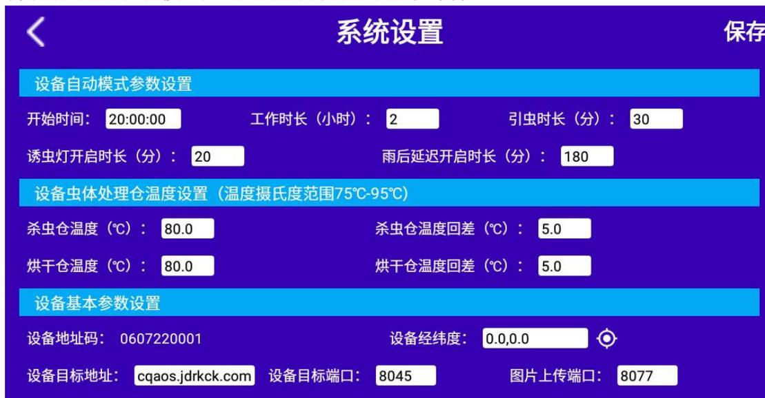
系统设置界面可以设置，开始时间、工作时长、引虫时长、诱虫灯开启时长、雨后延迟开启时长、杀虫烘干仓温度、设备目标地址、端口等参数。
